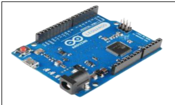
شكل (٣): لوحة Arduino Leonardo
